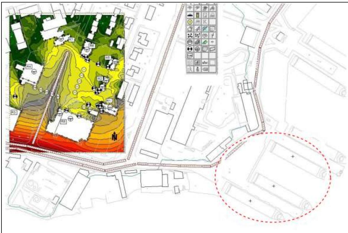
Nella costruzione del modello, in relazione alla necessità di procedere con un'analisi di dettaglio e riscontro, sono stati definiti ed introdotti nella cartografia (si faccia riferimento agli allegati: elaborato Mappe di report del modello acustico) anche dei punti di controllo (ovvero recettori fittizi per il modello), identificabili come piccoli cerchi bianco-neri.
