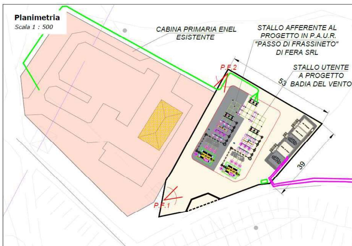
Figura 22 - stralcio elaborato 4.35A – area di intervento con vista della SE esistente gestita da E-Distribuzione e il nuovo stallo utente
