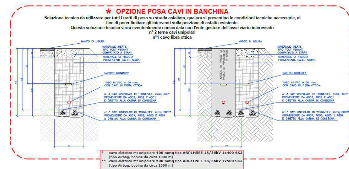
Figura 16 - Stralcio elaborato “4.18C_Planimetria Linea Elettrica su CTR - Pianta e Sezioni”, soluzione di posa delle due terne di cavi unipolari su banchina, lato strada
