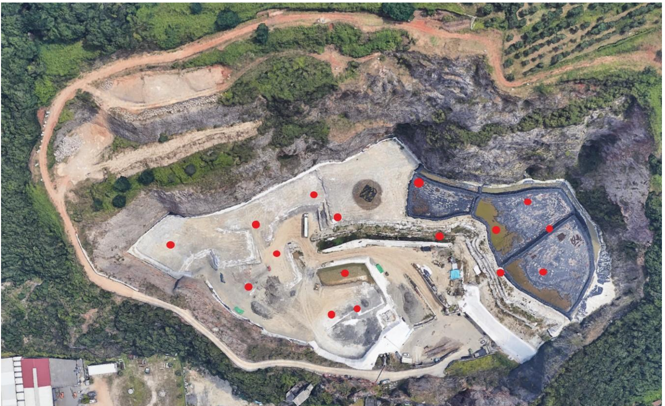
Pianta della discarica con posizione dei tubi di drenaggio
