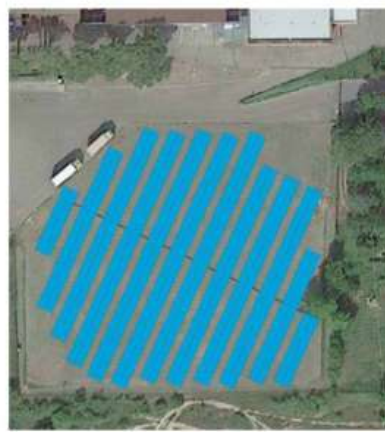
layout impianto fotovoltaico – campo "B"
