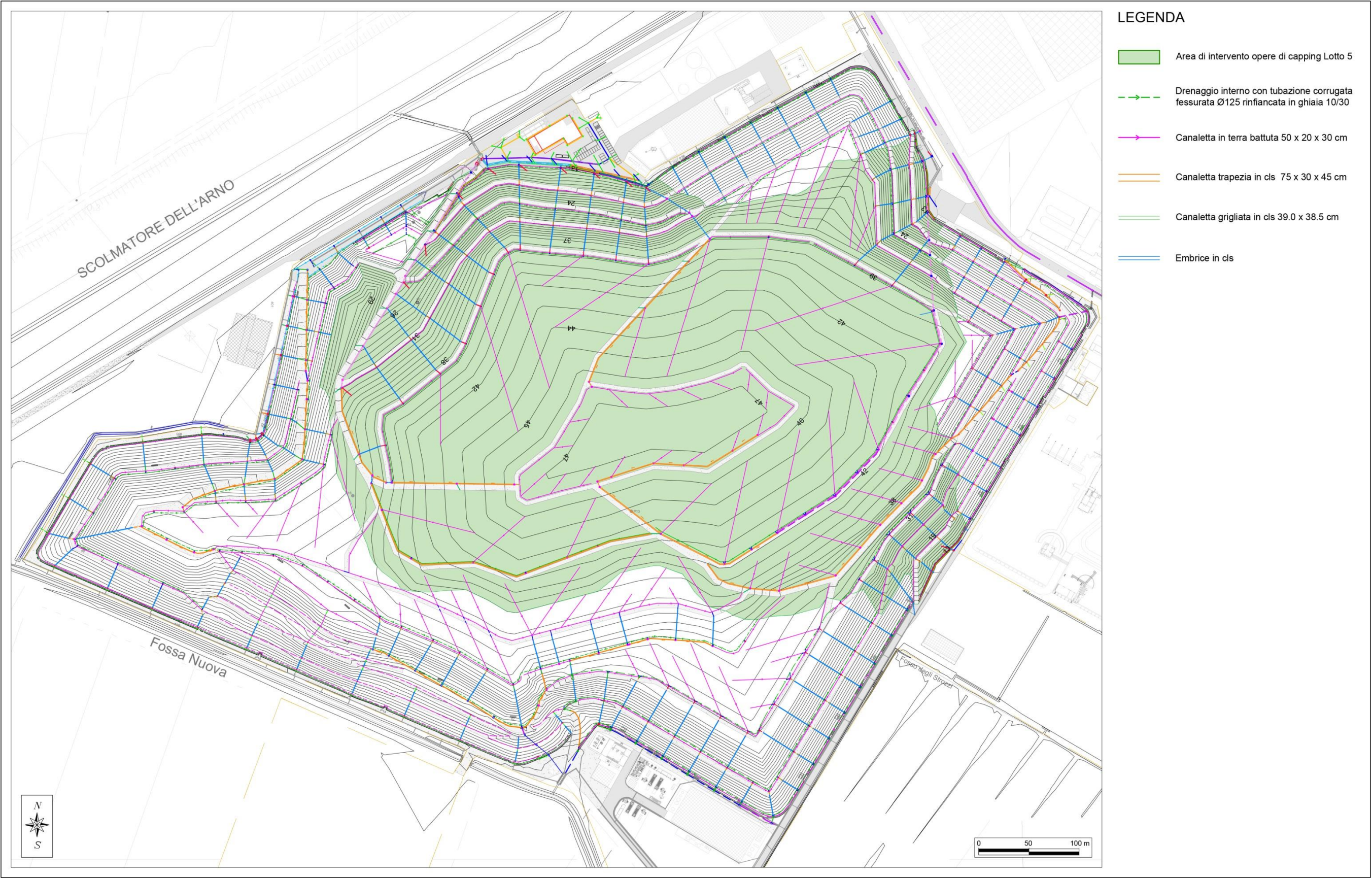
Figura 4:69 – Rete di regimazione acque meteoriche corpo discarica
