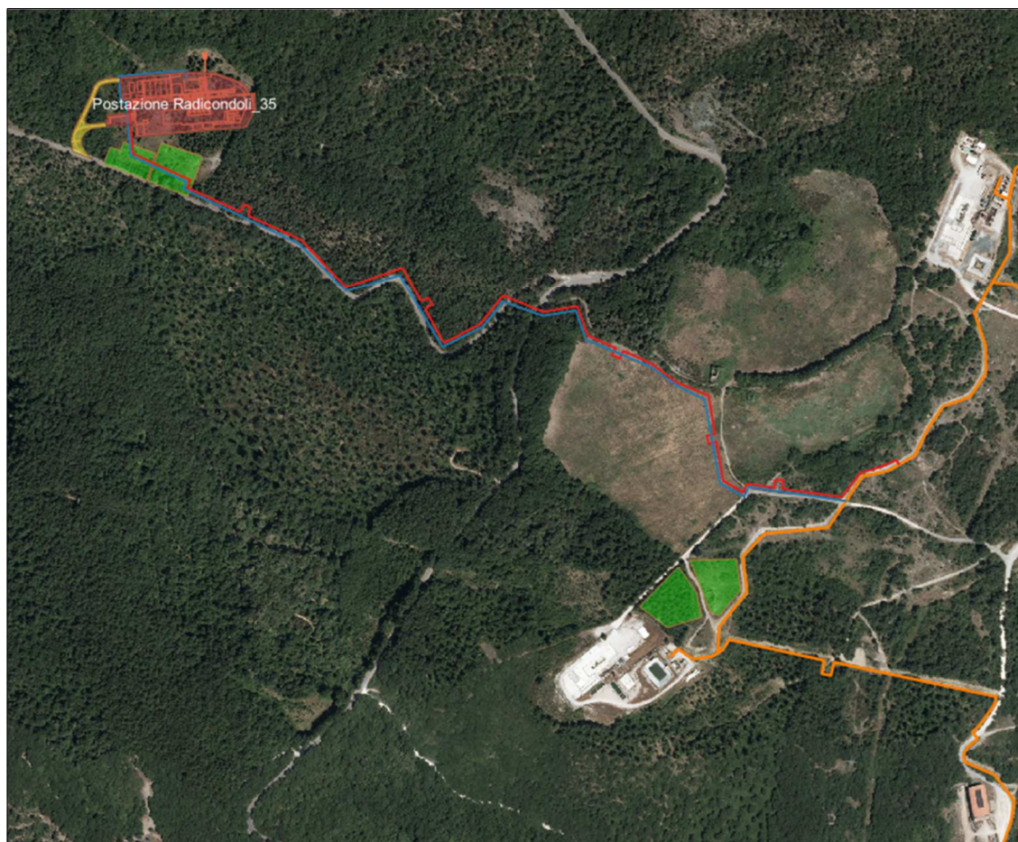
Figura 2: Vista aerea dell'area di ubicazione della nuova postazione Radicondoli 35 e del tracciato delle linee fluidi (in rosso vaporedotto, in blu acquedotto e in arancione rete fluidi esistente)
