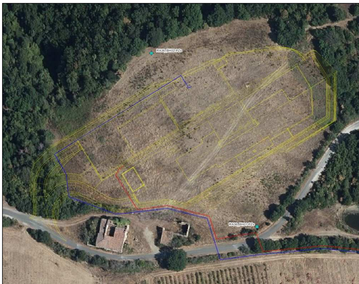
Figura 3-16: Planimetria delle indagini ambientali con indicati in azzurro i punti di campionamento.
