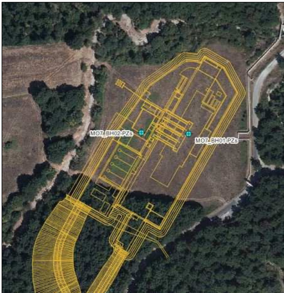
Figura 3-7: Piano indagini geognostiche. Planimetria con indicati in color ciano i piezometri superficiali.
