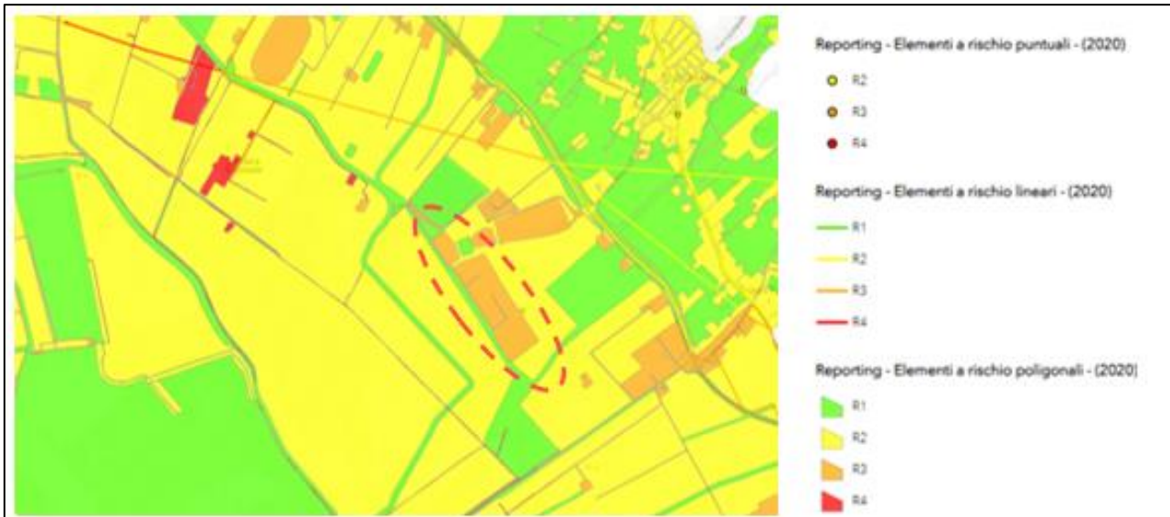
Figura 7 - Vista su stabilimento CMSA SPA nel PGRA - Distretto Bacino Appennino Settentrionale – Bacino dell'Arno Mappa del Rischio idraulico (Fonte sito web: https://geodata.appenninosettentrionale.it )
