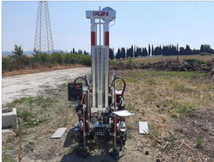
Figura 3: Postazione prova penetrometrica CPT 3
