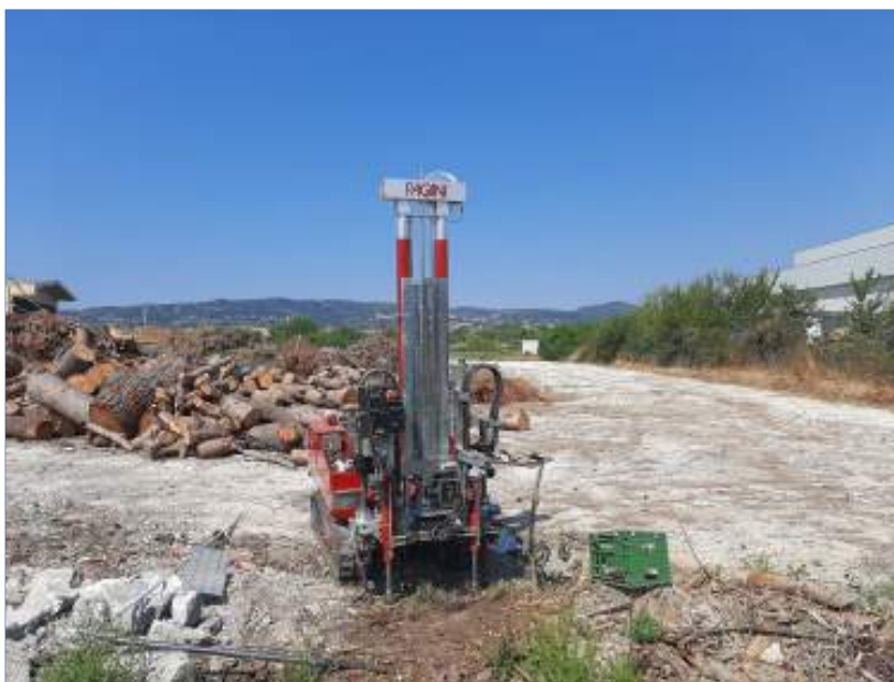
Figura 2: Postazione prova penetrometrica CPT 2
