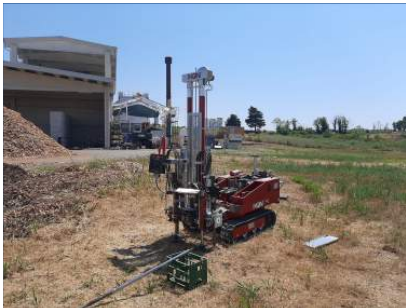
Figura 5: Postazione prova penetrometrica CPT 5
