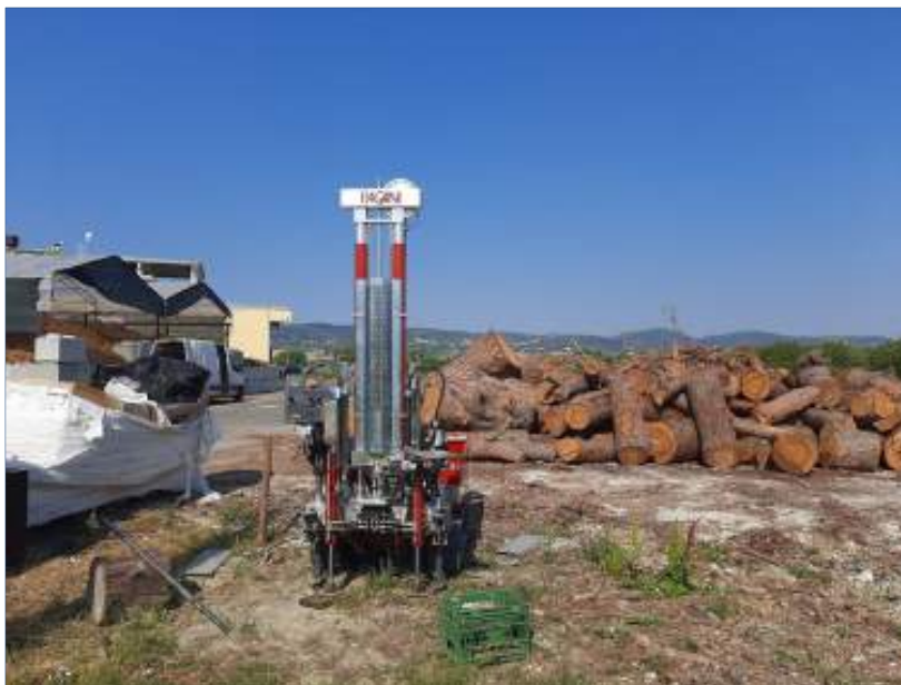
Figura 1: Postazione prova penetrometrica CPT 1
