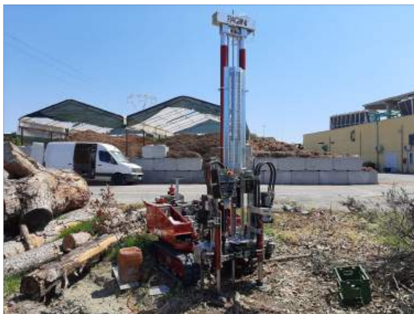
Figura 6: Postazione prova penetrometrica CPT 6
