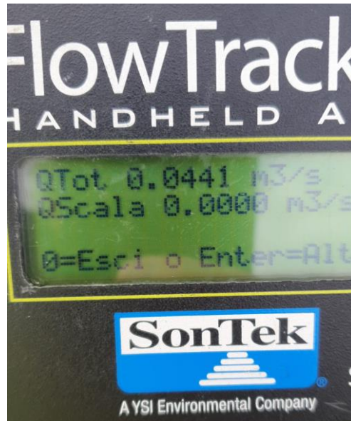
Immagine 1 Prima misura di portata su Molino di Mezzo
