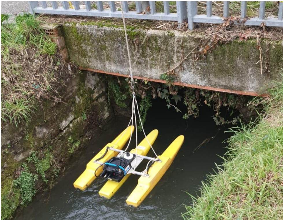
Immagine 8 Misura di portata canale Nuovo
