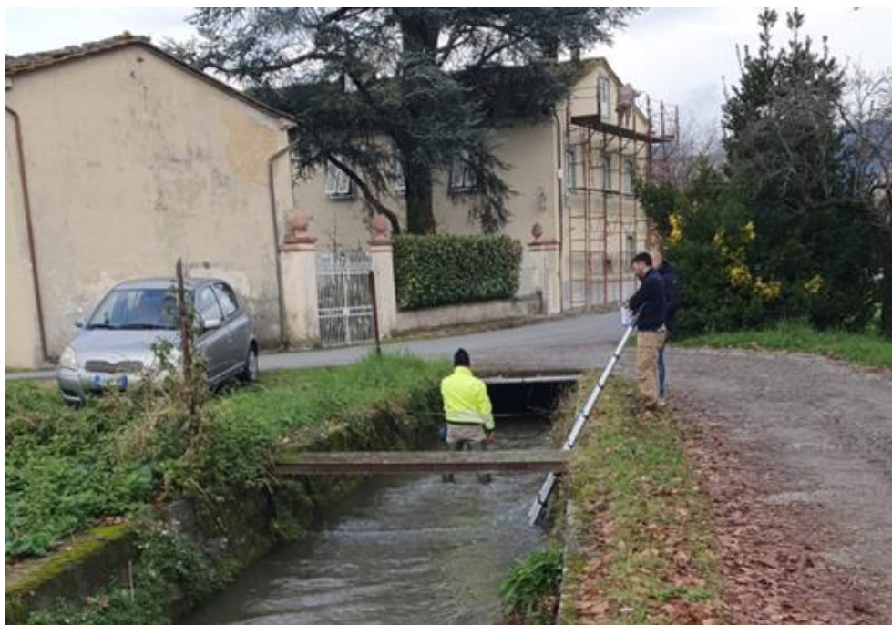
Immagine 3 Misura di portata canaletta Fanuccio
