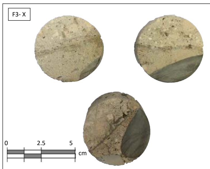
Figura 42 – Campioni F3-X1, F3-X2 e F3-X3 selezionati per le prove di assorbimento capillare, si nota la discontinuità che separa in due porzioni distinte il campione.
