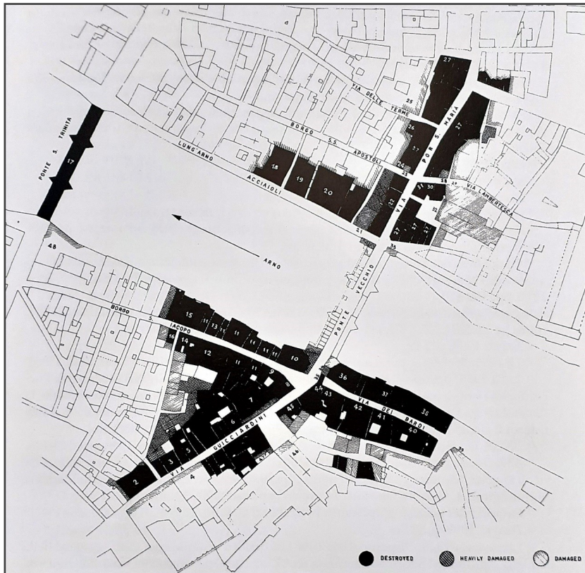
1944 Gli edifici distrutti o danneggiati dalle mine tedesche (da Hartt 1949)
