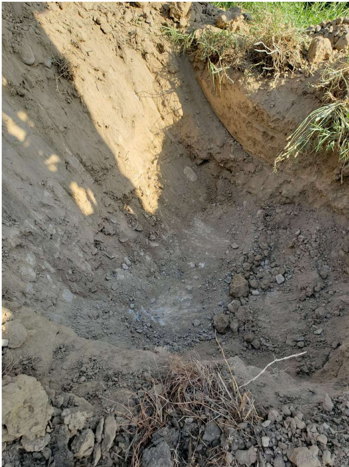
Saggio 2 con materiale resistente a -0,5 m dalla sommità dell'argine
