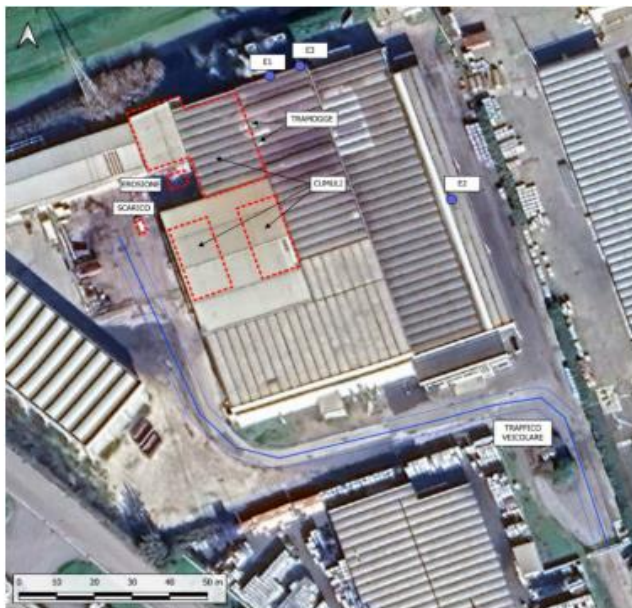
Figura 7.4/1. Individuazione schematica delle emissioni convogliate presenti in AIA (E1, E2, E3) e delle sorgenti di tipo diffuso derivanti dalle attività di movimentazione e stoccaggio dei materiali in ingresso all'impianto
