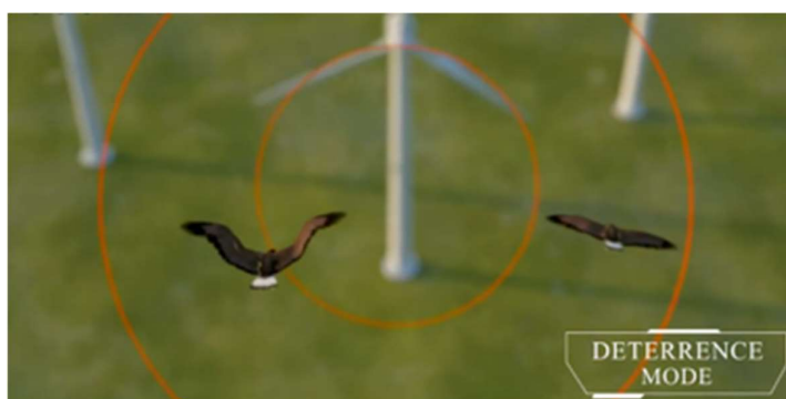
Figura 9: Deterrence mode - Dissuasione, mediante l'emissione di un segnale acustico udibile dal volatile
