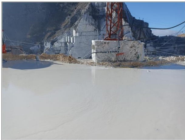
Foto 26 – Riesta di contenimento realizzata sul perimetro della bancata
