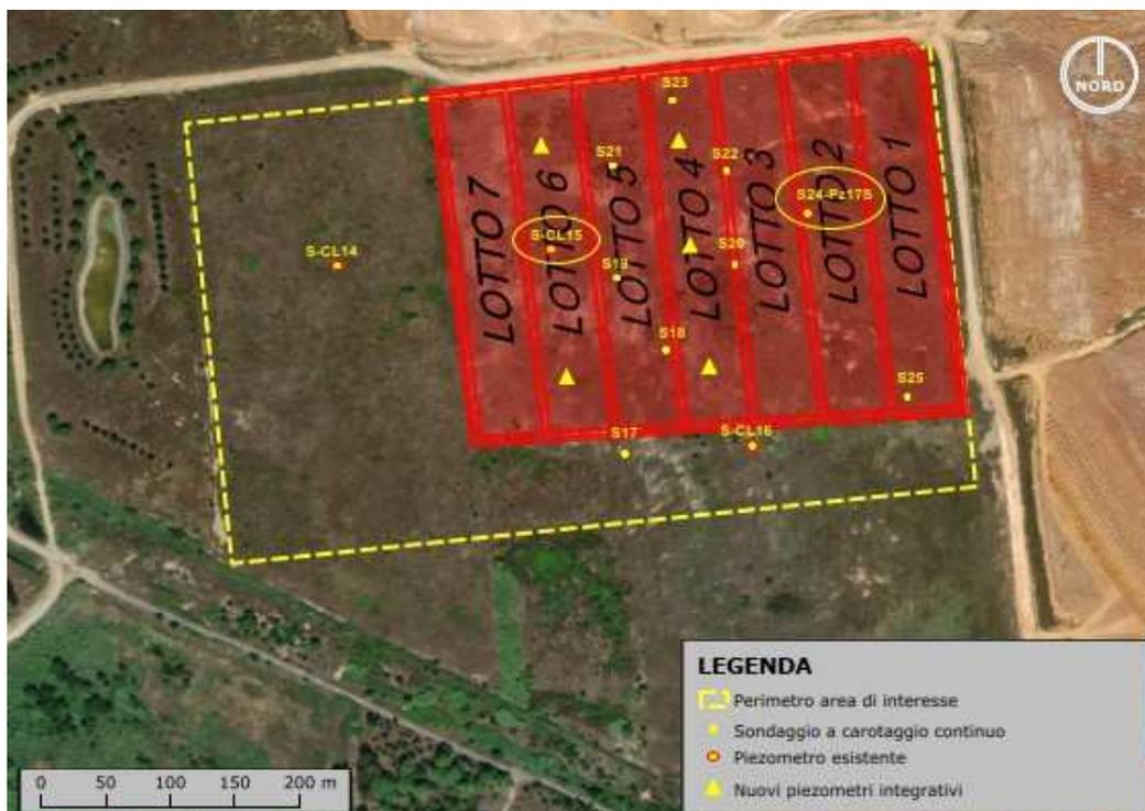
**Figura 10: Ubicazione nuovi punti integrativi per il monitoraggio delle acque di impregnazione nell'area di costruzione della nuova discarica di gessi**
