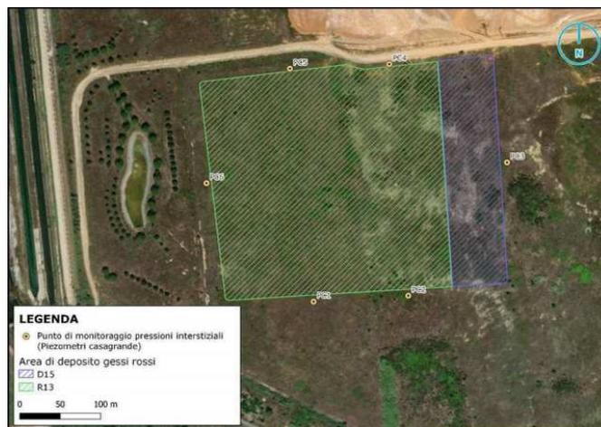
**Figura 7: Schema di posizionamento dei piezometri di Casagrande nell'area di riferimento**
