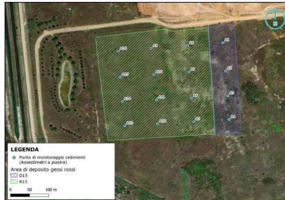
**Figura 5: Schema di massima di posizionamento degli assestimetri a piastra nell'area di riferimento**
