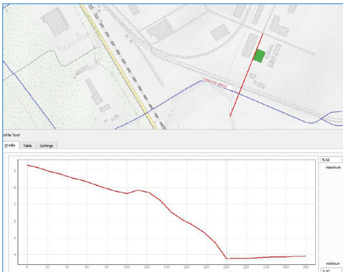
Figura 10 – Bacini idrografici inseriti all'interno del DTM con evidenziato in blu il Reticolo Regionale e le varie superfici interne all'area industriale oggetto di intervento (in verde), mentre in basso è riportato l'estratto del profilo altimetrico del lotto, lungo la direzione indicata in pianta con la linea rossa.
