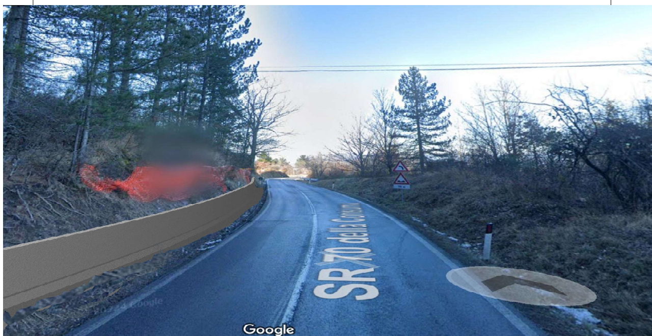
FOTO 2 - curva stato di progetto: realizzazione di un muro controripa sul lato di monte strutturalmente concepito in cemento armato, di altezza fuori terra non superiore a 1,50 m
