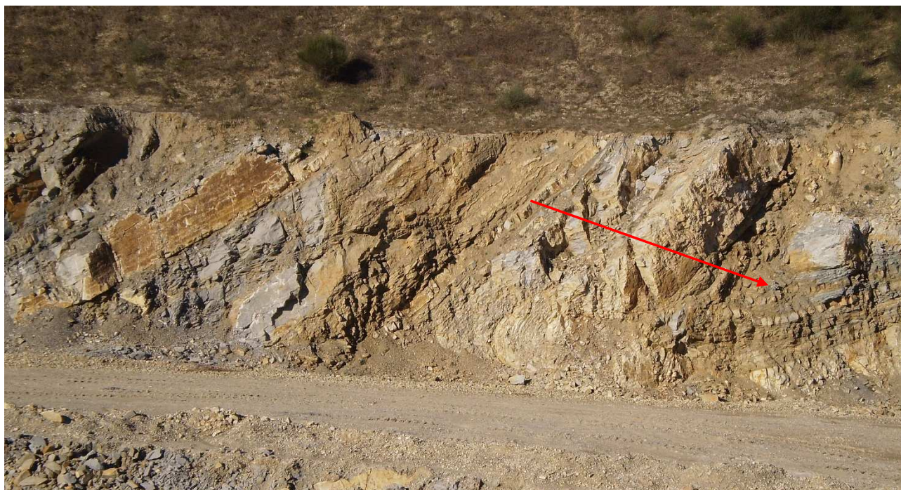
Fig 11: Presenza di accavallamenti nell'area ovest del Cantiere A
