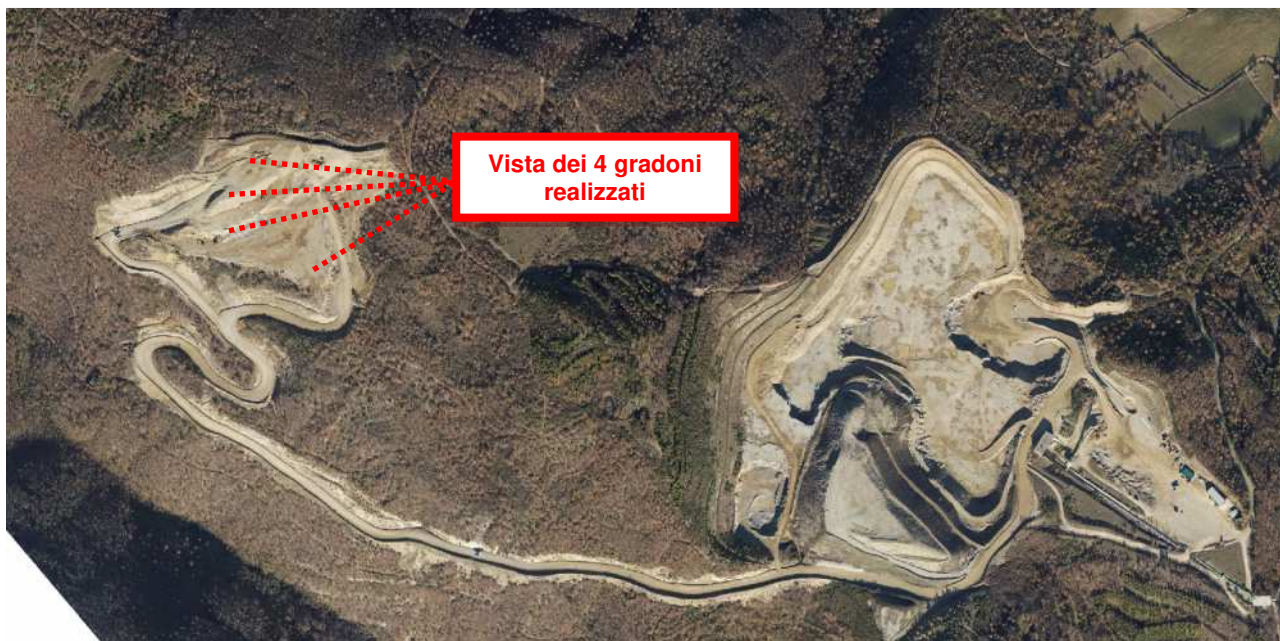
Figura 6 - Stato realizzato del cantiere relativo alla Concessione 2009 - vista dei 4 gradoni
