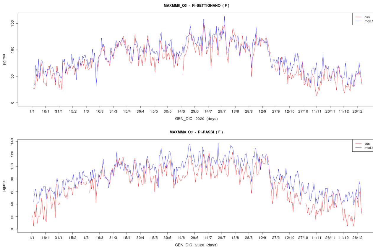
Figura 43. Serie storiche di confronto tra i dati di MAXMM8(O3) da stazione (rosso) e da modello (blu) relative alle stazioni di FI-Settignano e PI-Passi.
