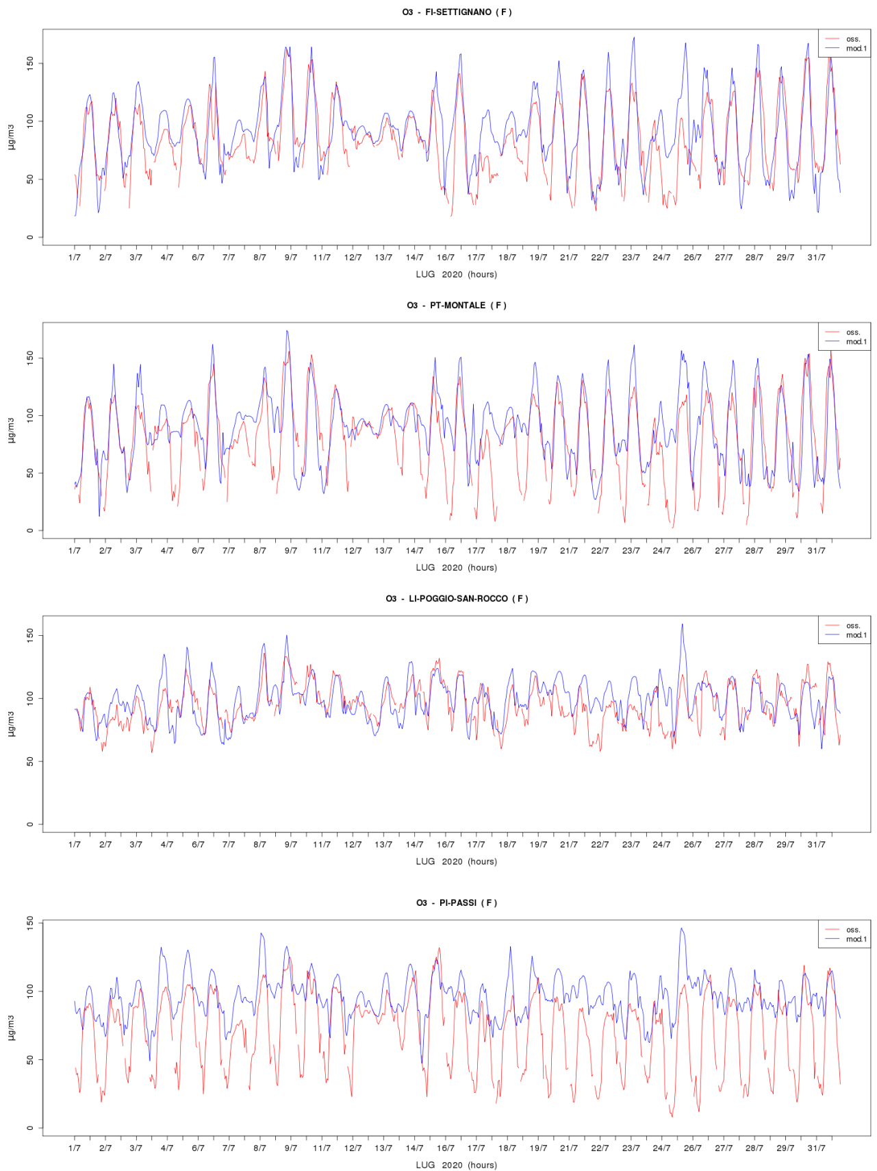
Figura 44. Serie storiche di confronto tra i dati di O3 da stazione (rosso) e da modello (blu), presso le stazioni di FI-Settignano, PT-Montale, LI-Poggio San Rocco e PI-Passi, nel mese di luglio 2019.
