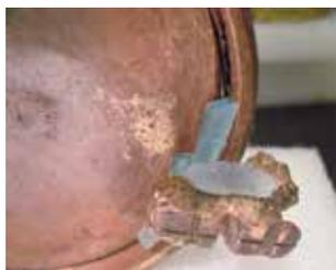
fig. 7 una delle fasi di pulitura, eseguita sulla parte inferiore del contenitore, con l'applicazione di una sostanza chelante, supportata dal gel rigido Agar.
