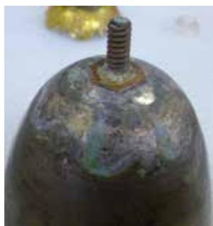
fig. 10 la parte inferiore della coppa, come si presentava al momento dello smontaggio. Sono ben visibili l'intervento di saldatura a stagno e le tracce del disossidante che hanno provocato la corrosione del metallo e la sua solfurazione.
