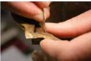
fig. 8 una fase della rimozione meccanica dei prodotti di corrosione del rame mediante l'ausilio di una punta metallica.
