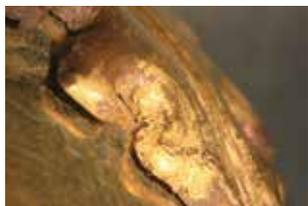
fig. 2 foto al microscopio ottico di un frammento di doratura ad amalgama di mercurio localizzato nel sottocoppa. È evidente la caratteristica consistenza “spugnosa” dell’oro, causata dall’evaporazione del mercurio dopo il suo riscaldamento, localizzata in un sottosquadro, non lavorato a brunitura.
