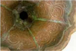
fig. 5 la corrosione del rame nella parte interna del piede.
