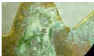
fig. 2 alcuni dei sali di corrosione del rame situati all'interno del sottocoppa.
