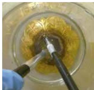
fig. 9 pulitura del sottocoppa nei Sali di Rochelle
