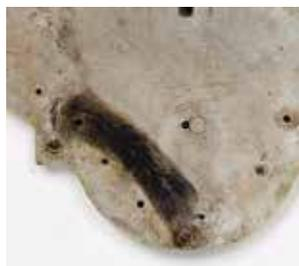
fig. 12 retro di una lamina d'argento, dove si riconosce una prova di solforazione effettuata a pennello con "fegato di zolfo"
