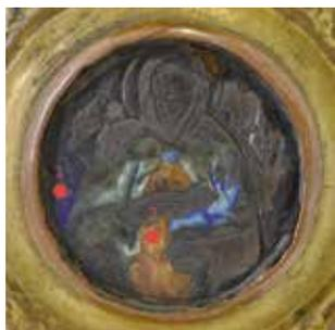
fig. 5 i punti di indagine con fluorescenza a raggi X (XRF). L'indagine ha individuato, in entrambi i punti di misura, la presenza di silicio, potassio (fondente), calcio, ferro (presente come impurezza, conferisce una colorazione verde allo smalto), manganese (inserito volontariamente per eliminare la colorazione verde del ferro), detto anche "sapone dei vetrai".
