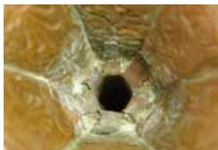
fig. 3 un particolare della struttura interna terminante in linguette di metallo saldate al piede.
