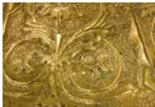
fig. 4 la corrosione del rame dorato.
