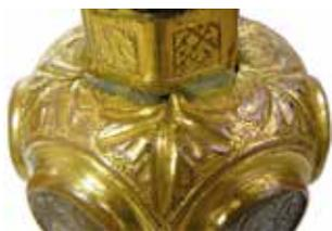
fig. 12 un particolare del nodo durante la rimozione dei sali di corrosione a carico del rame, avvenuta mediante l'applicazione di una soluzione chelante di Sali di Rochelle, supportata dal gel Agar. La colorazione verde è conferita al gelificante dai sali, resi solubili dalla soluzione.
