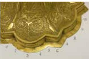
fig. 7 risultati delle prove di pulitura dei prodotti oleo-cerosi.
