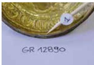
fig. 8 all'interno del coperchio è stato individuato il punto da indagare mediante la spettrometria a raggi x.
