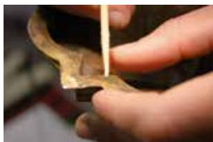
fig. 9 la fase della rimozione dei prodotti di corrosione del rame, avvenuta mediante tamponi di cotone idrofilo imbevuti di sostanze chelanti.
