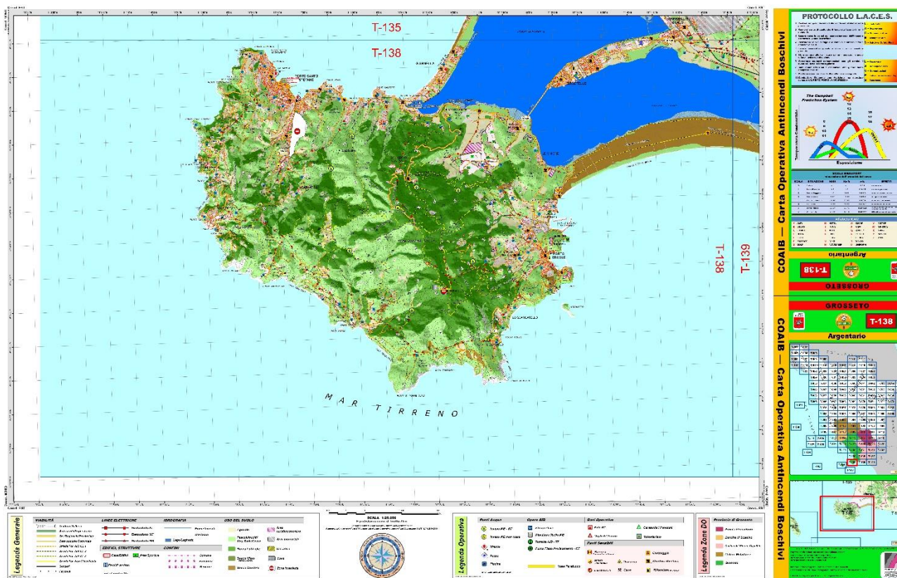
Figura 6.5 - Cartografia operativa AIB T-138 zona Argentario in scala 1:25.000 ed è una rappresentazione cartografica in UTM metrica con sistema di coordinate geografiche LL in formato D°M°S° DATUM WGS 84.
