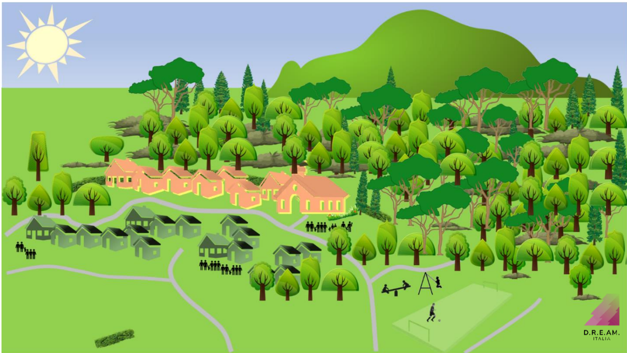
Figura 8.26 - Disegno con evidenziate abitazioni poste in zone di interfaccia urbano-bosco in cui non è stata prevista una fascia di interfaccia (disegno D.R.E.A.M.-Italia ©).
