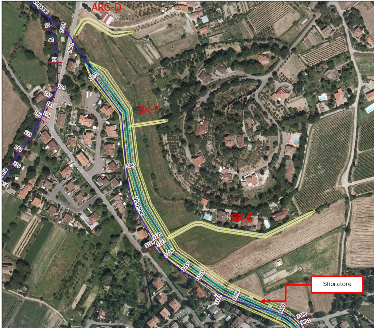
Figura 29. Intervento riassetto Vingone in tratto adiacente a Bagnoro ed interventi pennelli Montoncello.
