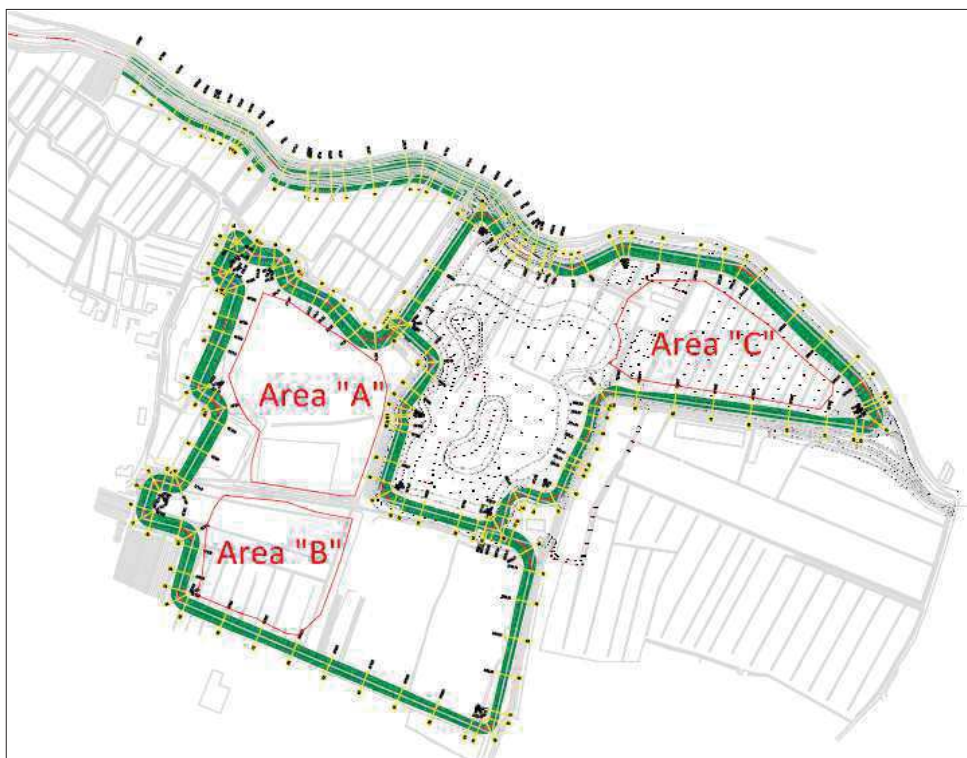
Schema funzionale della cassa di espansione
